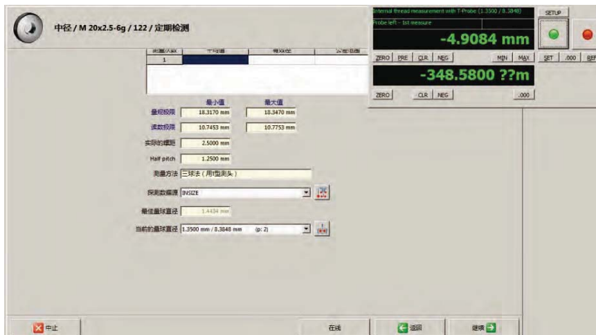
螺纹环塞规测量软件(选配), 根据环塞规代号自动选择标准并计算, 提示每一步的操作。 测量完成后直接显示测量结果并判定是否合格, 可生成报告
